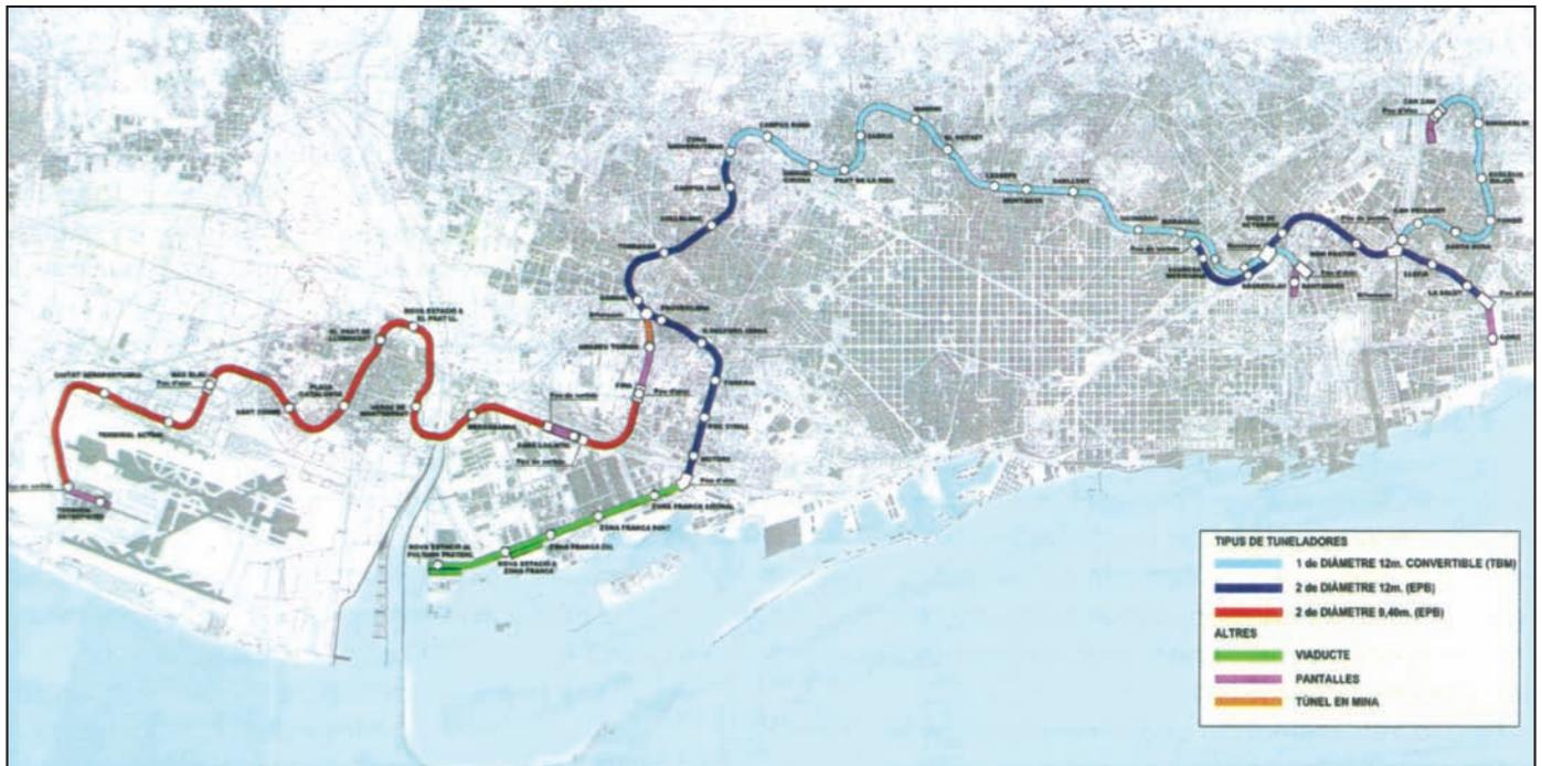
Fig 5 - Les divers modes de construction de la ligne 9
