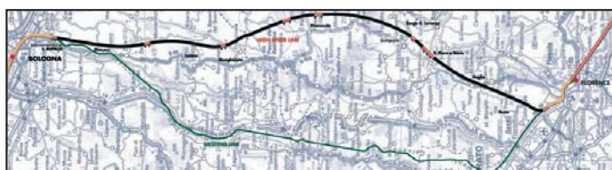
Figure 8 : Traversée de l'Apennin entre Bologne et Florence : ligne "direttissima" en vert grâce au tunnel de 19 km percé dans les années 30, et ligne nouvelle en noir, souterraine à près de 90 % (un long tunnel autoroutier est prévu à son tour).
