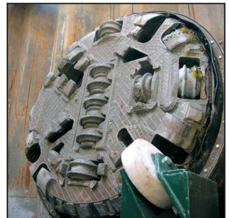
Vue de la roue d'attaque du tunnelier.
