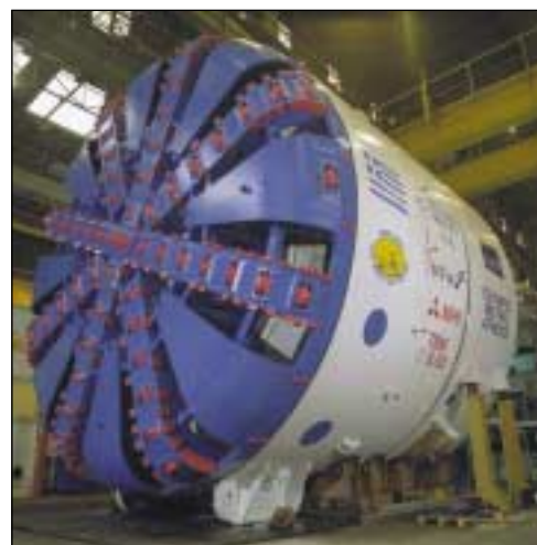
Photo 4.2.3 Bouclier mécanisé ouvert à appui longitudinal Métro d'Athènes (Grèce)
