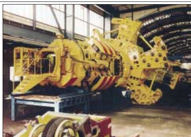
Photo 4.1.4 - Aléseur - Tunnel de Sauges (Suisse)
