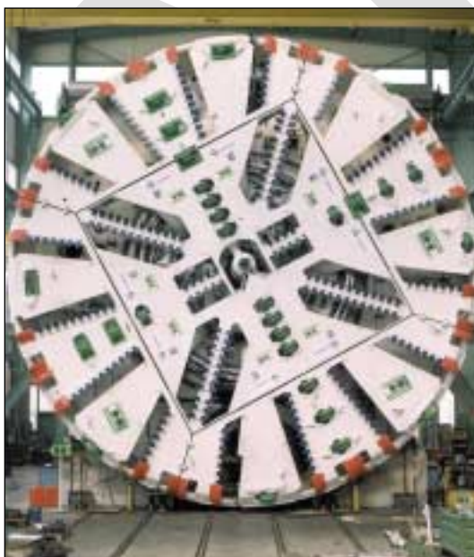
Photo 4.3.6a Bouclier mécanisé à confinement mixte Tunnel de l'Ouest Parisien, A86
