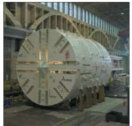
Photo 4.3.6b - Bouclier mécanisé à confinement mixte Métro de Madrid (Espagne)
