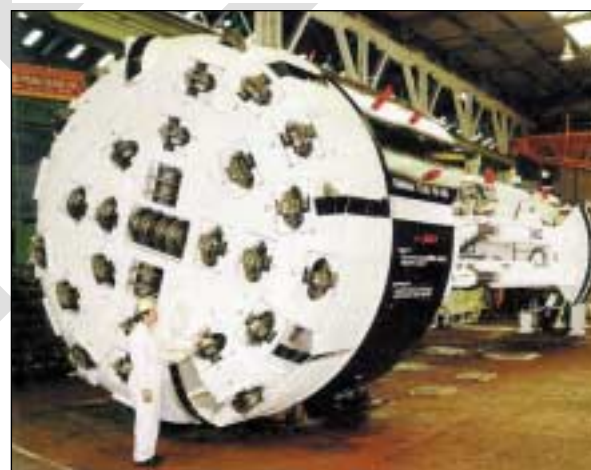
Photo 4.1.3 - Tunnelier à appui radial Lesotho Highland Water Project (Lesotho)
