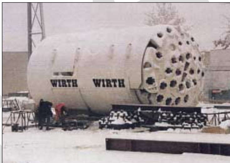
Photo 4.2.2 - Bouclier mécanisé ouvert à appui radial Tunnel Principal du CERN (France-Suisse)
