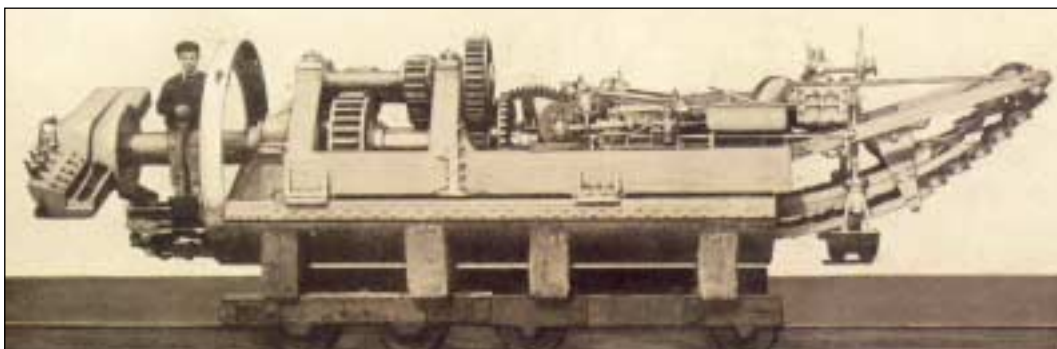
Perforatrice Beaumont construite en 1882 pour la première tentative de percement du tunnel sous la Manche (Société de Construction des Batignolles)
