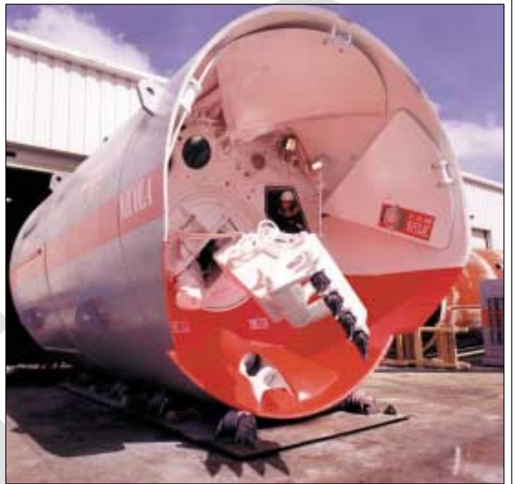
Photo 4.3.3 - Bouclier mécanisé à confinement d'air comprimé Emissaire, Moscou (CEI)
