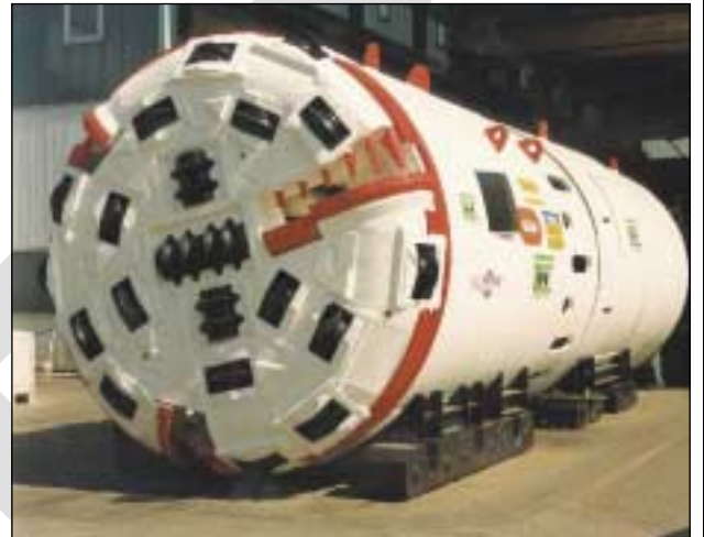
Photo 4.2.4 - Bouclier mécanisé ouvert à appui mixte Aménagement hydraulique de Salazie (Ile de la Réunion)
